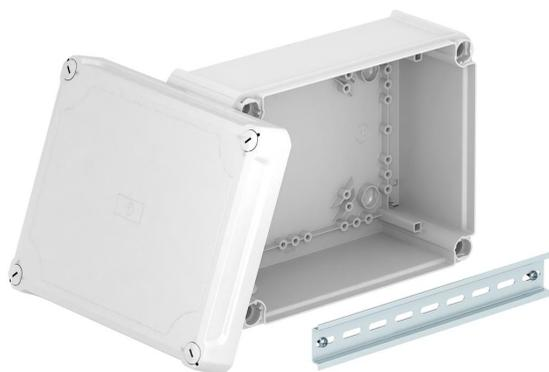
Kabelabzweigkasten geschlossen zum Verbinden von Kabeln und Leitungen im Innenbereich und geschützten Außenbereichen. Rechteckige Form ohne Einführungen. Geeignet für die Wand-/ Deckenmontage, die Montage auf Montageblechen und Gewinde im Boden. Mit der Möglichkeit zur Innenbefestigung und Montage über die Eckdome. Hoher Deckel mit Schnellverschluss, plombierbar. Hergestellt aus halogenfreien und UV-stabilisierten Materialien. Inklusive Hutprofilschiene.
